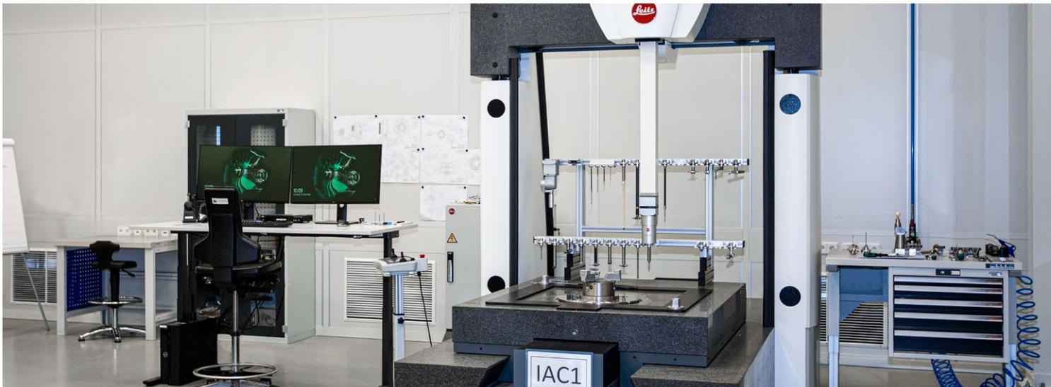
Wir haben höchste Ansprüche an unsere Messverfahren. Hierfür nutzen wir eine hochpräzise Koordinatenmessmaschine in einem Messraum der Klasse 1. So können die Dimensionen unserer Bauteile bis auf 1 Mikrometer genau erfasst werden.
